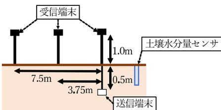
・学内のグラウンドにおいて，地中に設置した送信端末から空中の受信端末まで 920MHz 帯電波を送信した際の減衰量（受信電力）の変化を測定しました．
